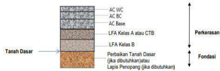
Gambar 2.4 Struktur perkerasan (Lalu Lintas Berat) pada Galian
