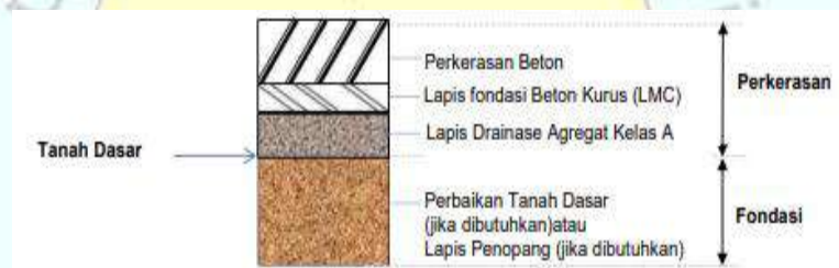
Gambar 2.5 Struktur perkerasan Kaku Pada Timbunan
