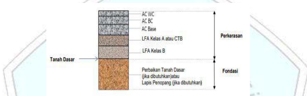
Gambar 2.2 Struktur perkerasan (Lalu Lintas Berat) pada Permukaan Tanah Asli ( At Grade )
