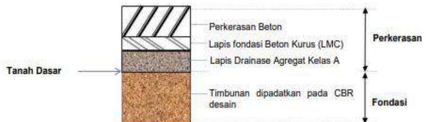
Gambar 2.6 Struktur perkerasan Kaku Pada Galian
