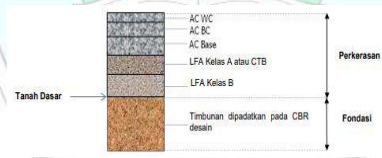
Gambar 2. 3 Struktur perkerasan (Lalu Lintas Berat) pada Timbunan
